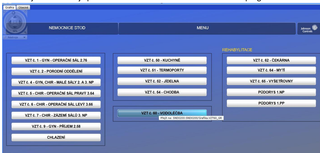
Obrázek 23 Systém Metasys (Johnson Controls)
