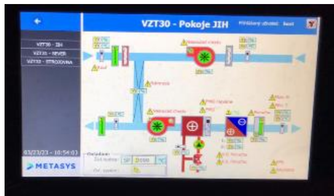
Obrázek 18 Regulační systém VZT Metasys
